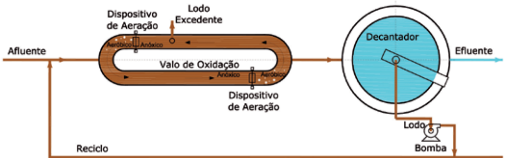
FIGURA 12.18 Valo de Oxidação
