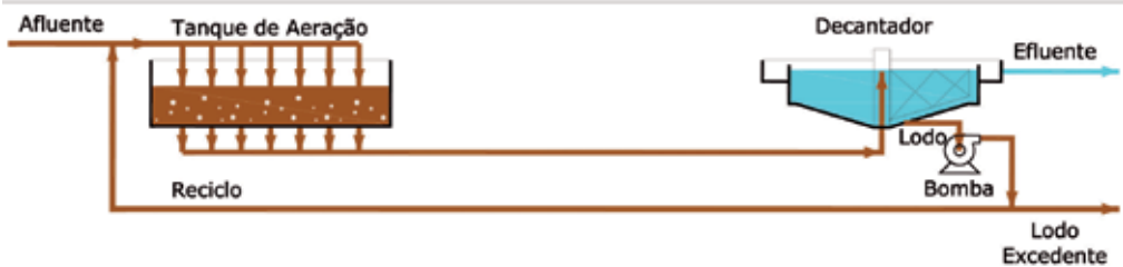
FIGURA 12.17 Lodos Ativados: Mistura Completa
