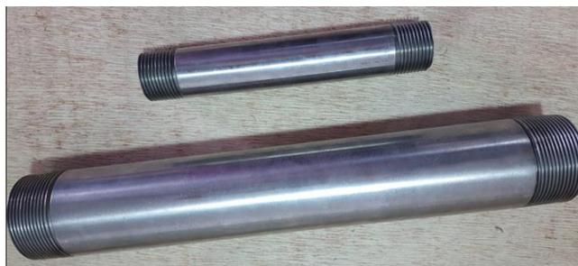
Misturadores estáticos com tamanhos de 1" e 2", fabricados em aço inoxidável AISI-304 e com extremidade com rosca BSP macho cônica. Possuem, internamente, 4 elementos de mistura, em aço inox AISI-304
