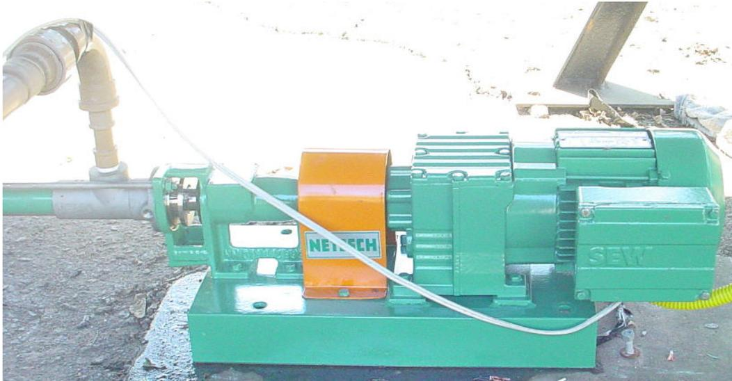
**Foto 10: Bomba hidráulica utilizada no sistema experimental de tratamento de águas cinzas**
