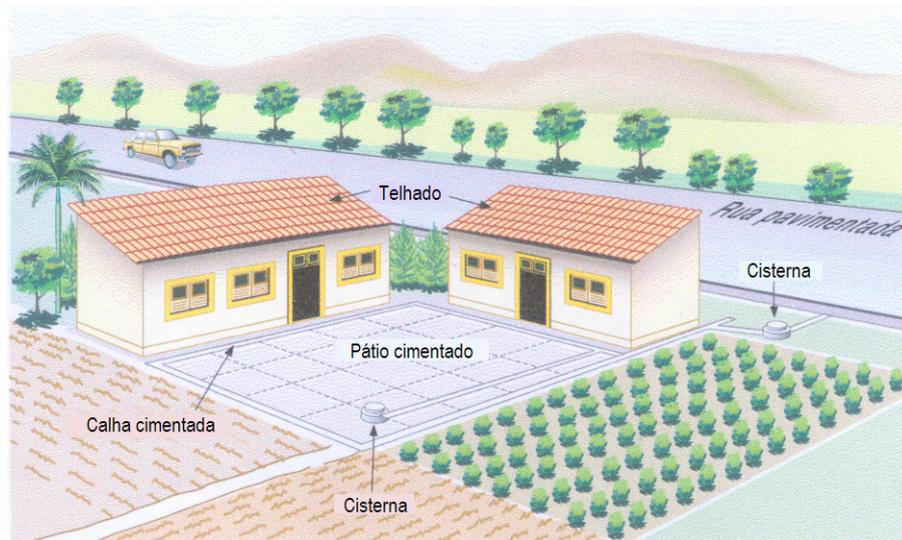
**Figura 7: Projeto de coleta de águas pluviais para irrigação**
