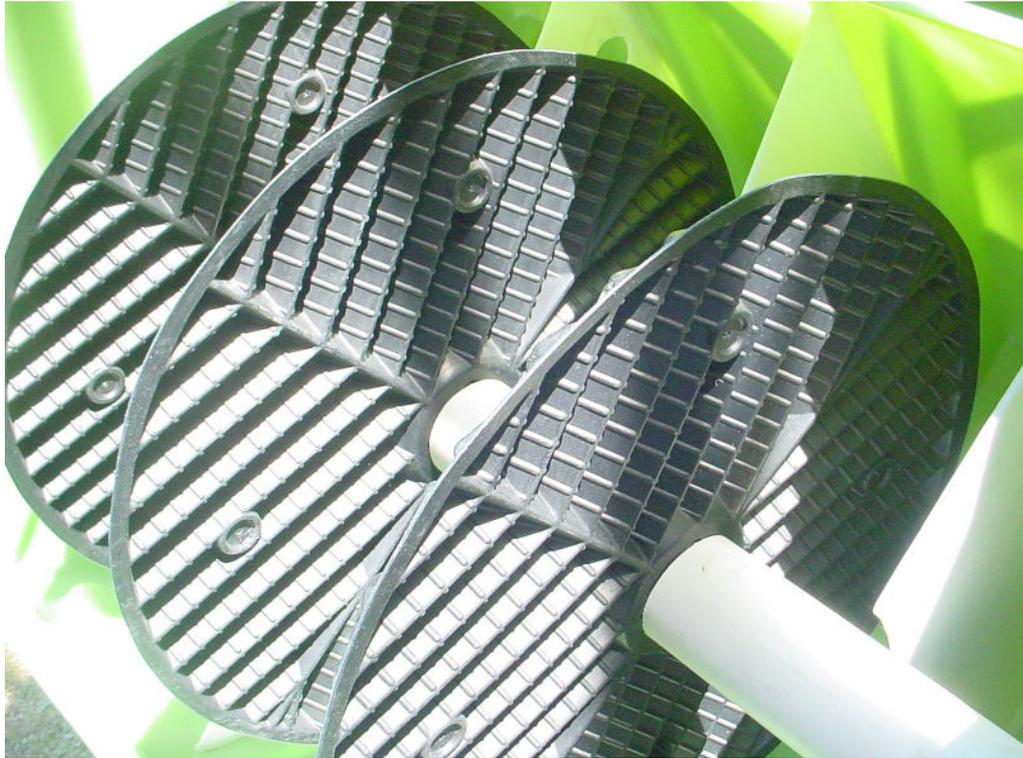
**Foto 12: Vista dos discos onde o biofilme é aderido**
