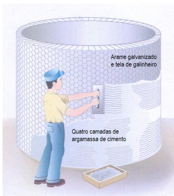
**Figura 4: Cisterna de concreto com tela de arame**
