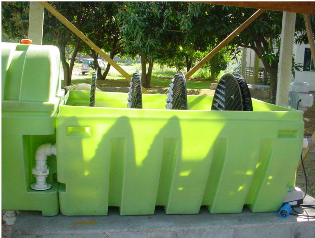
**Foto 11: Vista do sistema de biodisco para tratamento das águas cinzas residenciais**
