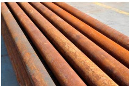
Figura 5. Exemplo de corrosão generalizada em tubos metálicos
