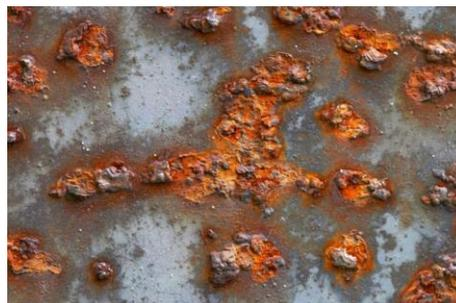
Figura 6. Exemplo de corrosão localizada
