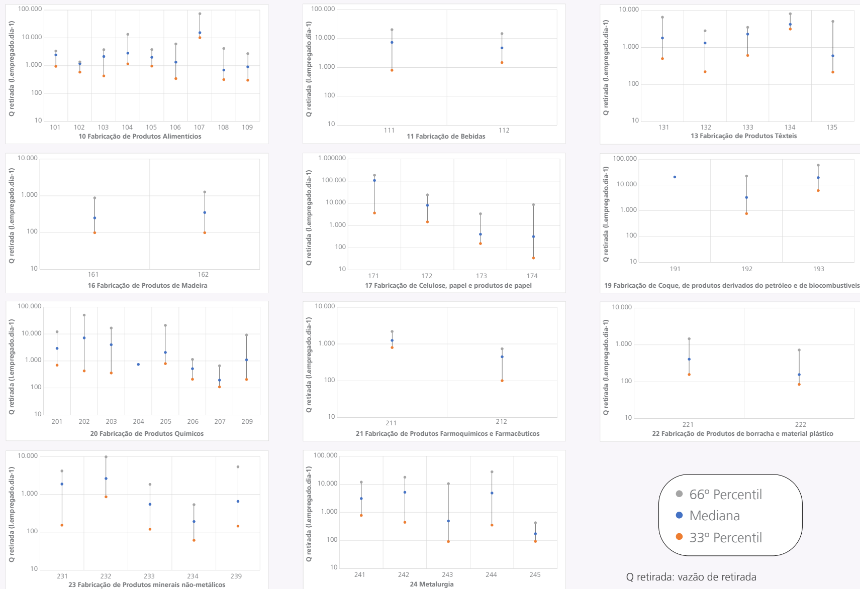
Figura 3. Faixas de coeficientes de retirada em nível hierárquico grupo para algumas divisões da CNAE 2.0
