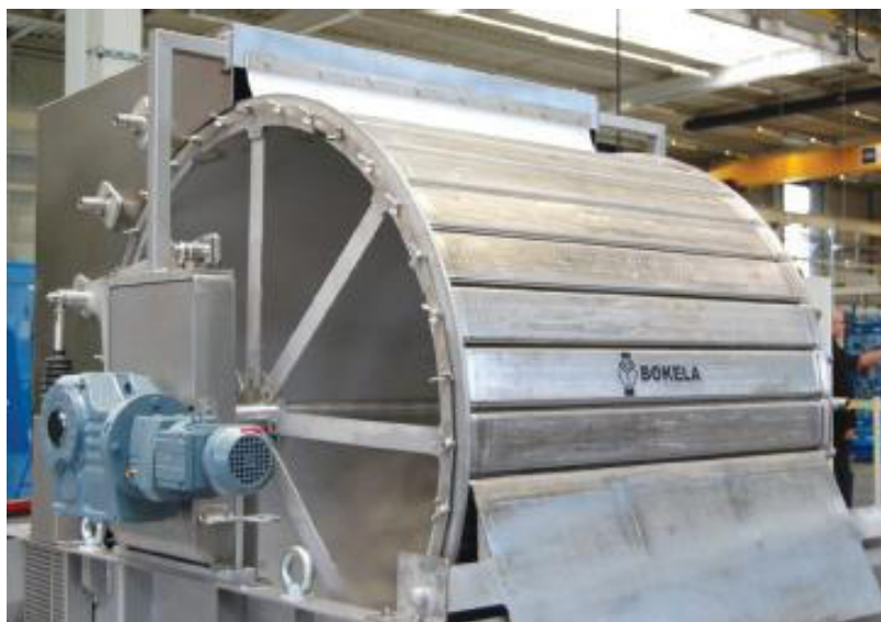
Figura 36 – Exemplo de filtro de tambor rotativo.
