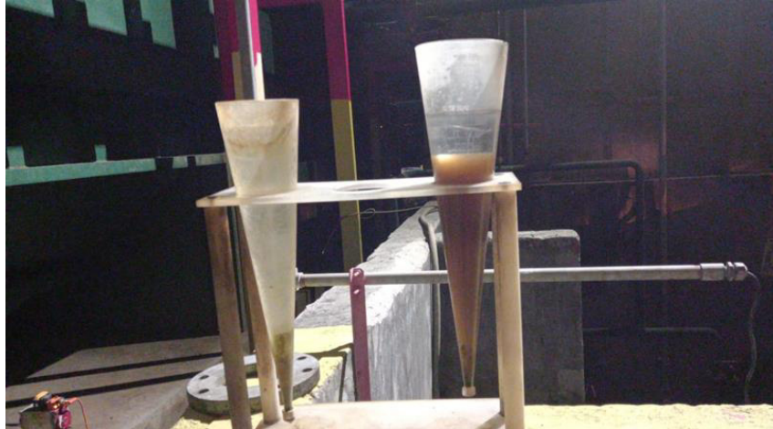
Figura 8 – Medição do residual de sólidos do decantador.
