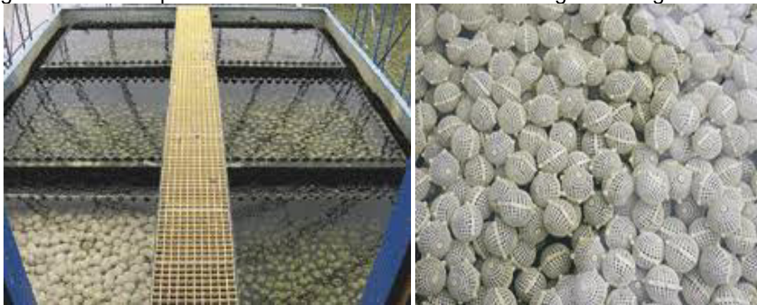
Figura 37 – Exemplo de mídias biofiltro utilizadas na filtração biológica de RAS.
