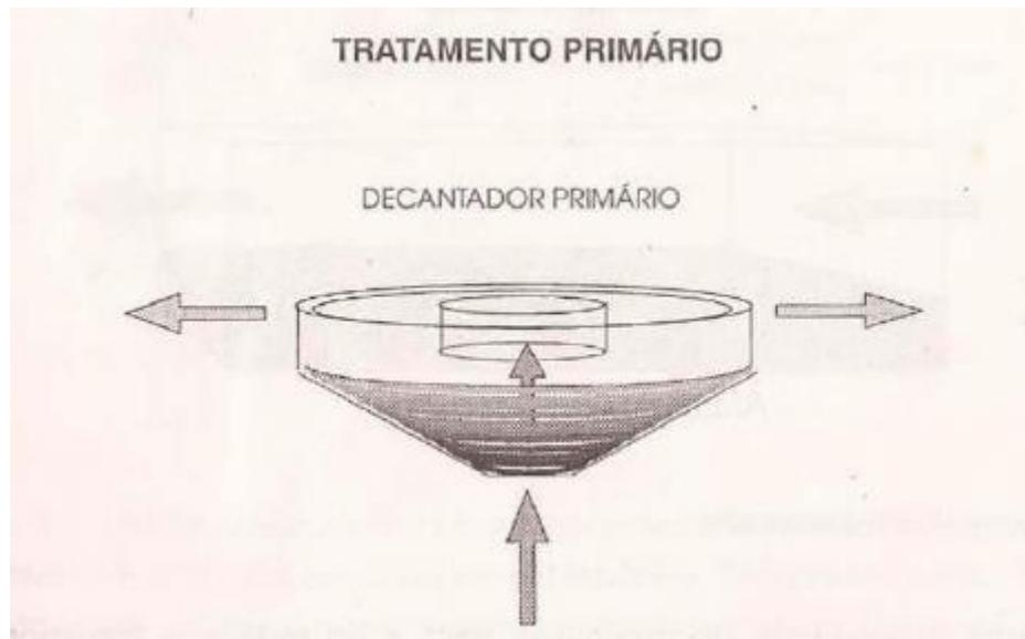
**Figura 15:** Esquema de um decantador primário circular.
