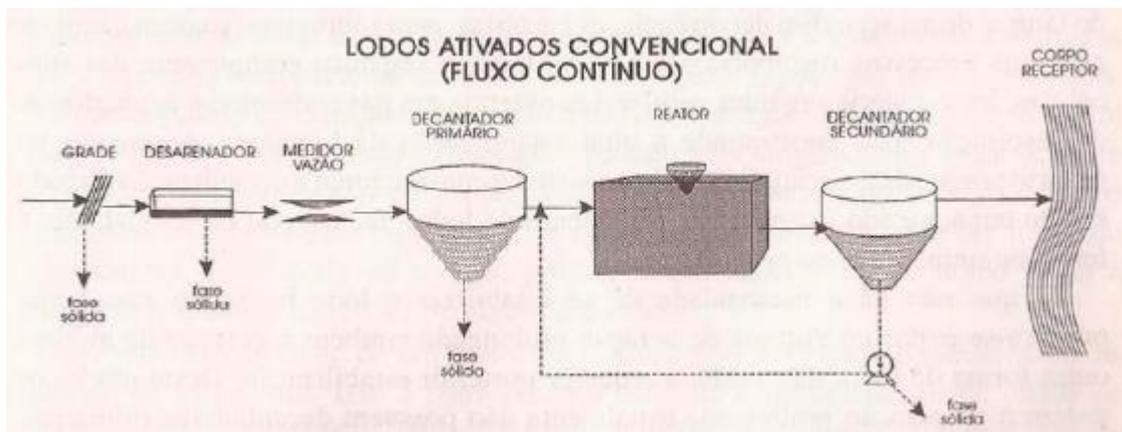
**Figura 20:** Fluxograma típico do sistema de lodos ativados convencional.
