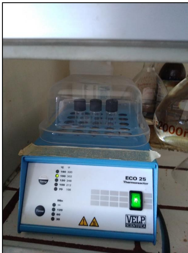
Figura 29 – Etapa de digestão a 150°C para determinação da CQO.
