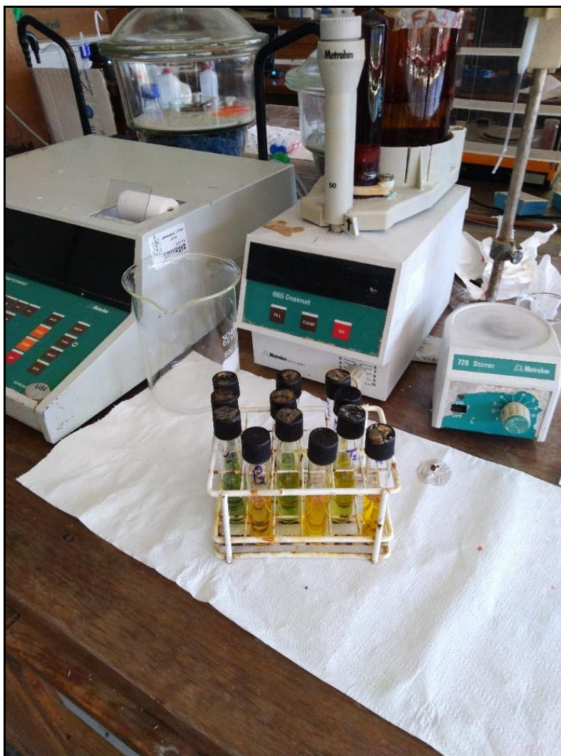
Figura 30 – Sistema de titulação utilizado para determinação da CQO.
