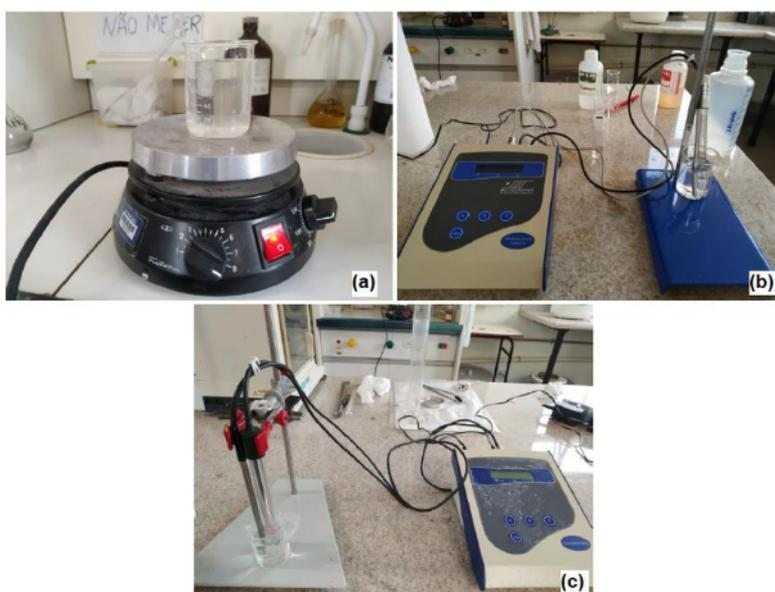
(a) equipamento utilizado no ensaio de sólidos totais; (b) equipamento utilizado para determinar o pH; (c) equipamento para determinação da condutividade elétrica.
