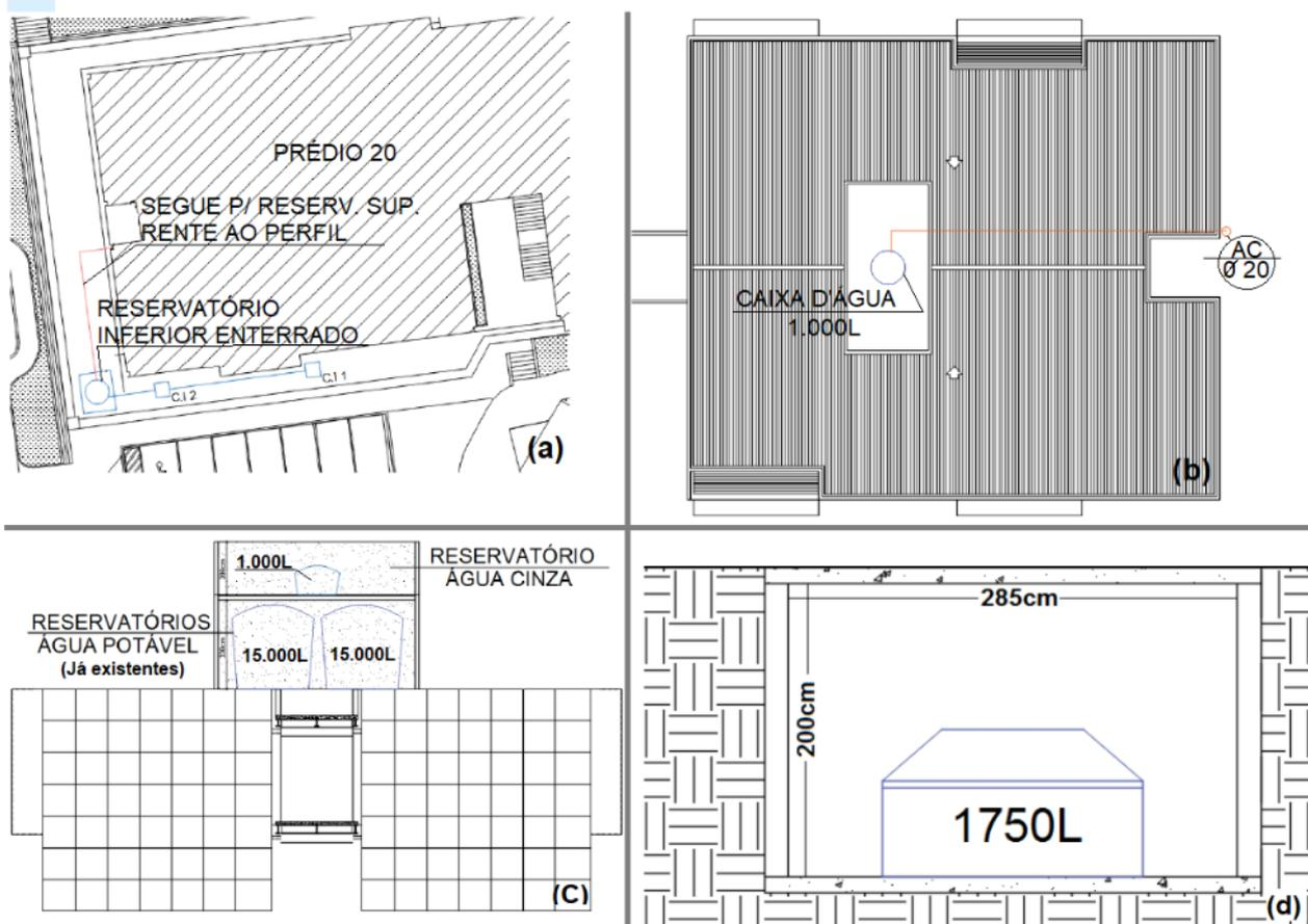
(a) Localização em planta do reservatório inferior enterrado. (b) Localização em planta do reservatório superior. (c) Vista lateral dos reservatórios de água potável e água cinza. (d) Corte do reservatório enterrado.
