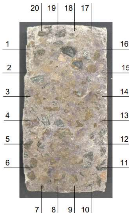
Figura 47. Penetração de íons cloro – medição
