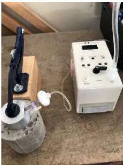
Figura 36. Ensaio para determinação de permeabilidade superficial com equipamento Porosiscopes™
