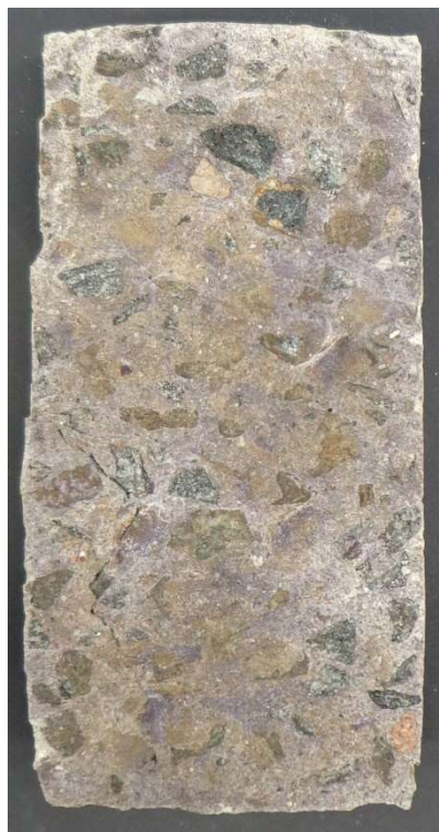
Figura 34. Corpo de prova após a aspersão de nitrato de prata
