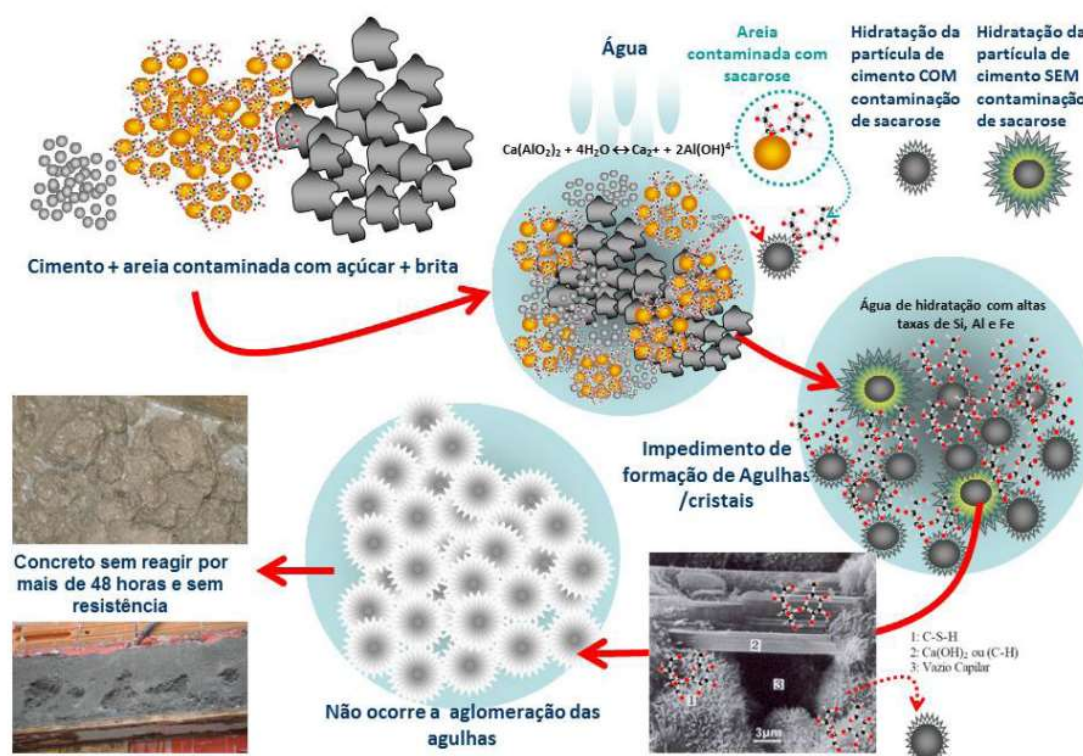
Figura 19. Processo de hidratação do cimento interrompido pelo açúcar
