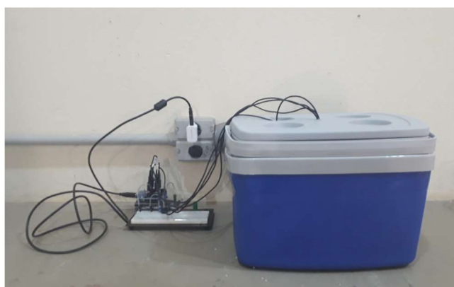
Figura 23. Aparato para o desenvolvimento do ensaio de calor de hidratação
