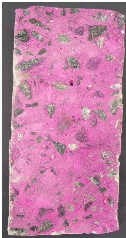
Figura 31. Corpo de prova após a aspersão de fenolftaleína
