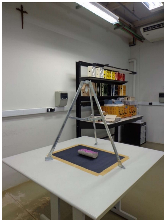
Figura 32. Tripé e corpo de prova após aspersão de fenolftaleína posicionado para as fotos
