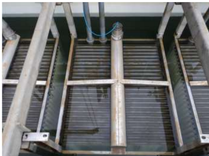
Figura 11. Cassete de membranas submersas
