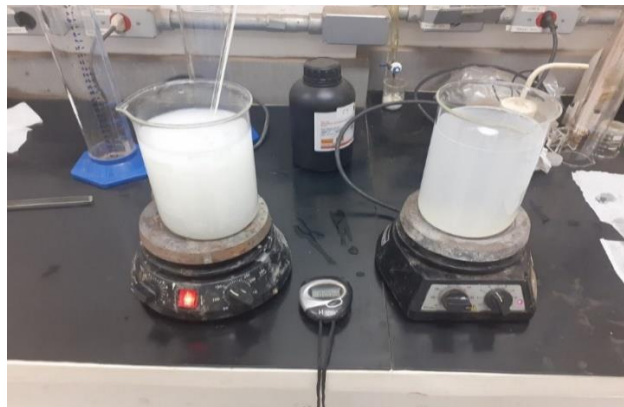
Figura 23. Fotografia do procedimento de gelatinização de amido em bancada. A direita, amido comercial, e a esquerda, amido PA.
