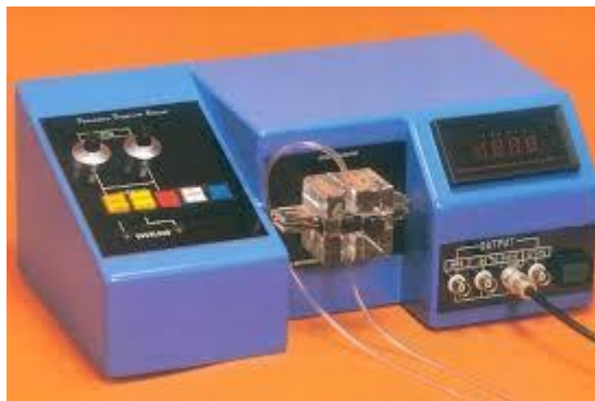
Figura 24. Analisador de Dispersão Fotométrica Rank Brothers (PDA2000).
