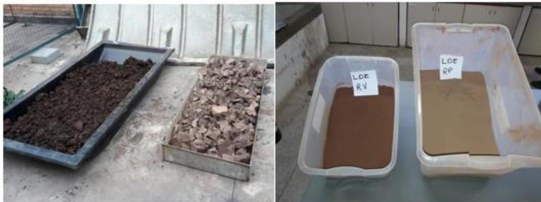
Figura 3: Secagem dos lodos, sendo: A esquerda o LDE–RV e o da direita o LDE–RP.
