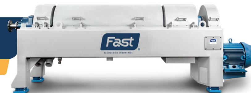
Equipamento adequado para a separação de sólido/líquido 1/líquido 2 de produtos, abrangendo três fases de pesos específicos diferentes (geralmente sólido, óleo e água). Tem grande emprego em desidratação de lodos, em separação de óleos ou em recuperação de substâncias processadas.
