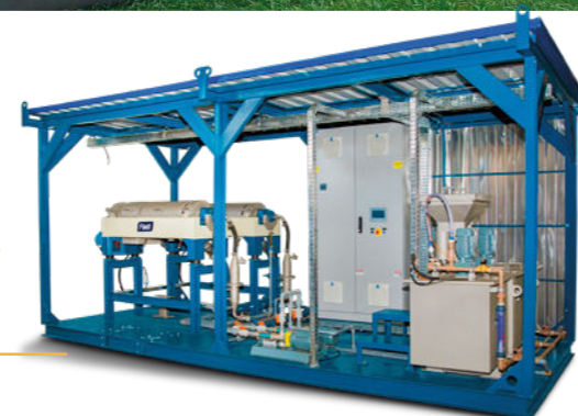
ETE em Skid
