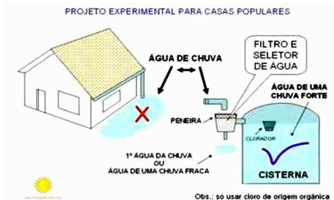
FIGURA 1 – captação da água da chuva.
