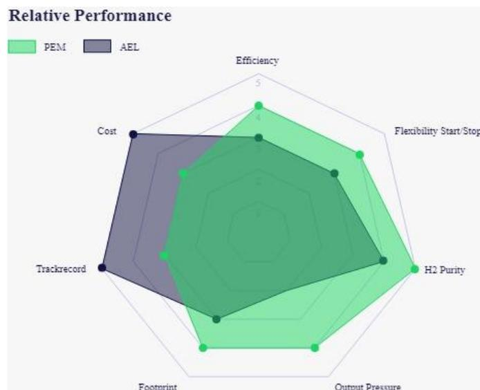
Figura 7 - Gráfico comparativo das duas tecnologias (PEM e Alcalina) (HyJack, 2021)
