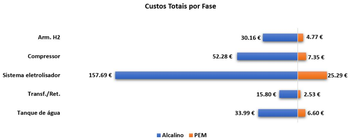
Figura 46 - Custos totais por fase do processo das tecnologias alcalina e PEM
