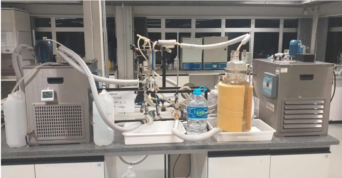
Figura 17. Equipamento de bancada de Destilação por Membrana de Contato Direto utilizado nos experimentos.
