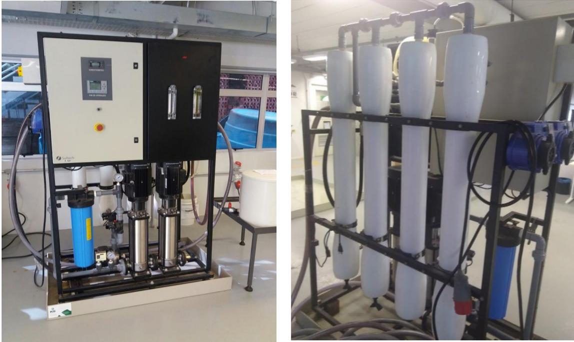
**Figura 19. Sistema piloto de OR utilizado nos experimentos.**
