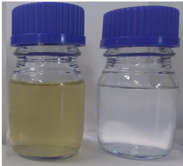
Figura 34. Aparência visual do CDM (esquerda) e do PDM (direita). Experimentos de DMCD em bancada com recirculação total. Amostras coletadas no final dos experimentos.
