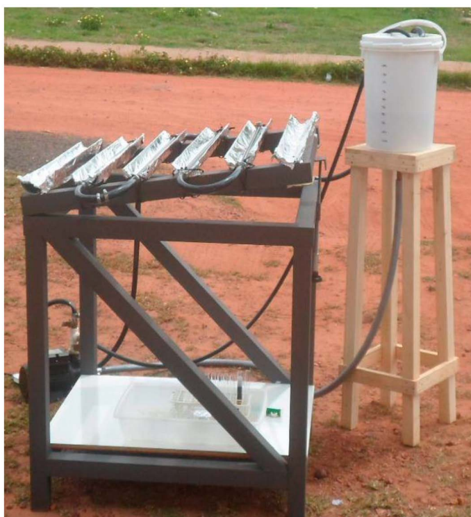
Figura 2. Fotorreator do tipo CPC construído para o processo Foto-Fenton irradiado por luz solar
