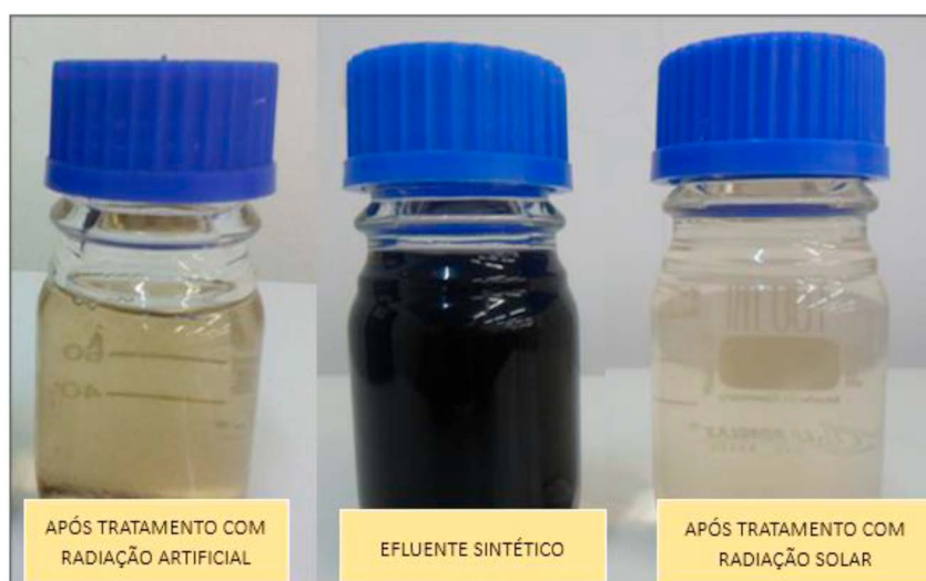
Figura 4. Resultado do processo de descoloração do efluente após 120 minutos de reação para a condição: C_{H_2O_2} :1500 mg L^{-1} e C_{Fe^{2+}} :75 mg L^{-1}
