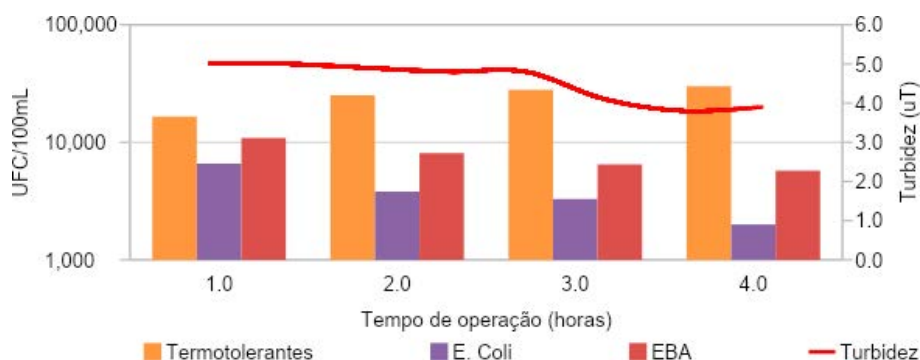
Figura 9 – Valores de coliformes termotolerantes, E. coli , EBA e turbidez ao longo da operação da ETA piloto com filtração rápida descendente para o reservatório Bodocongó
