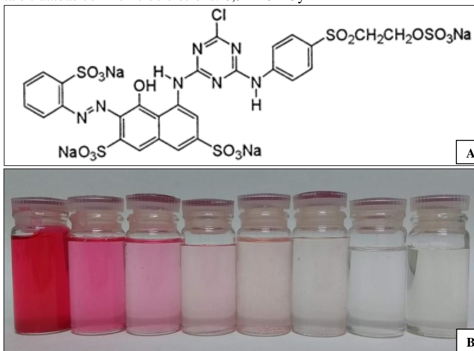
Figura 6 - A. Estrutura Molecular do corante reativo Red 239. B. Amostras de efluente têxtil bruta e tratadas com feixe de elétrons: 0,5 – 15 kGy
