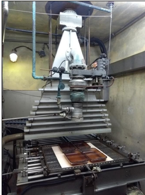
Figura 11 - Acelerador de Elétrons (IPEN/CETER) com amostras de efluente para irradiação
