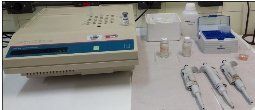
Figura 12 - Sistema Microtox®, ensaio com a bactéria V. fischeri
