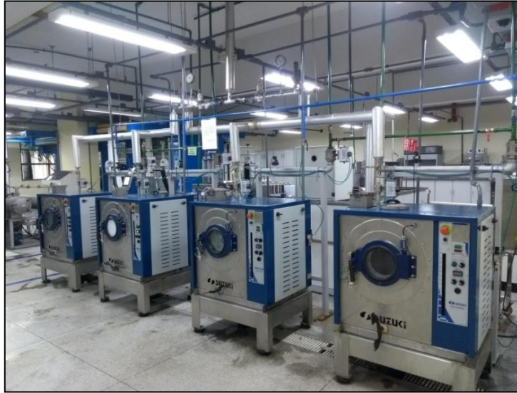
Figura 7 - Sequência de máquina lavadoras empregadas no tingimento têxtil, Laboratório pré-industrial (SENAI)
