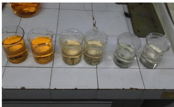
Figura. 3. Amostras antes e depois da aplicação do oxidante e ultrassom.
