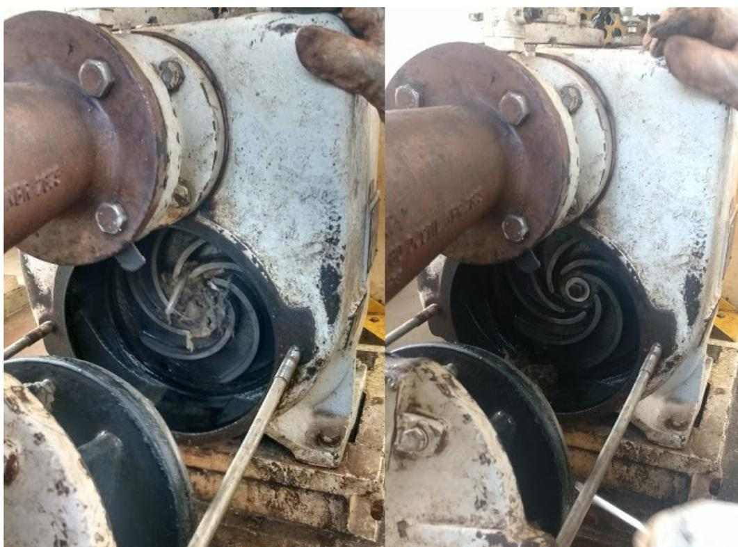
*Figura 58: Rotor da bomba antes e depois da limpeza*
