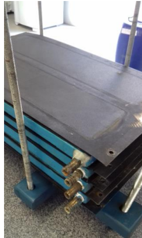
Figura 16: Eletrodos de titânio-rutênio ( \text{Ti}/(70\%)\text{TiO}_2 (30%) \text{RuO}_2 ) após a limpeza antes de iniciar os ensaios de Eletro-Oxidação.
