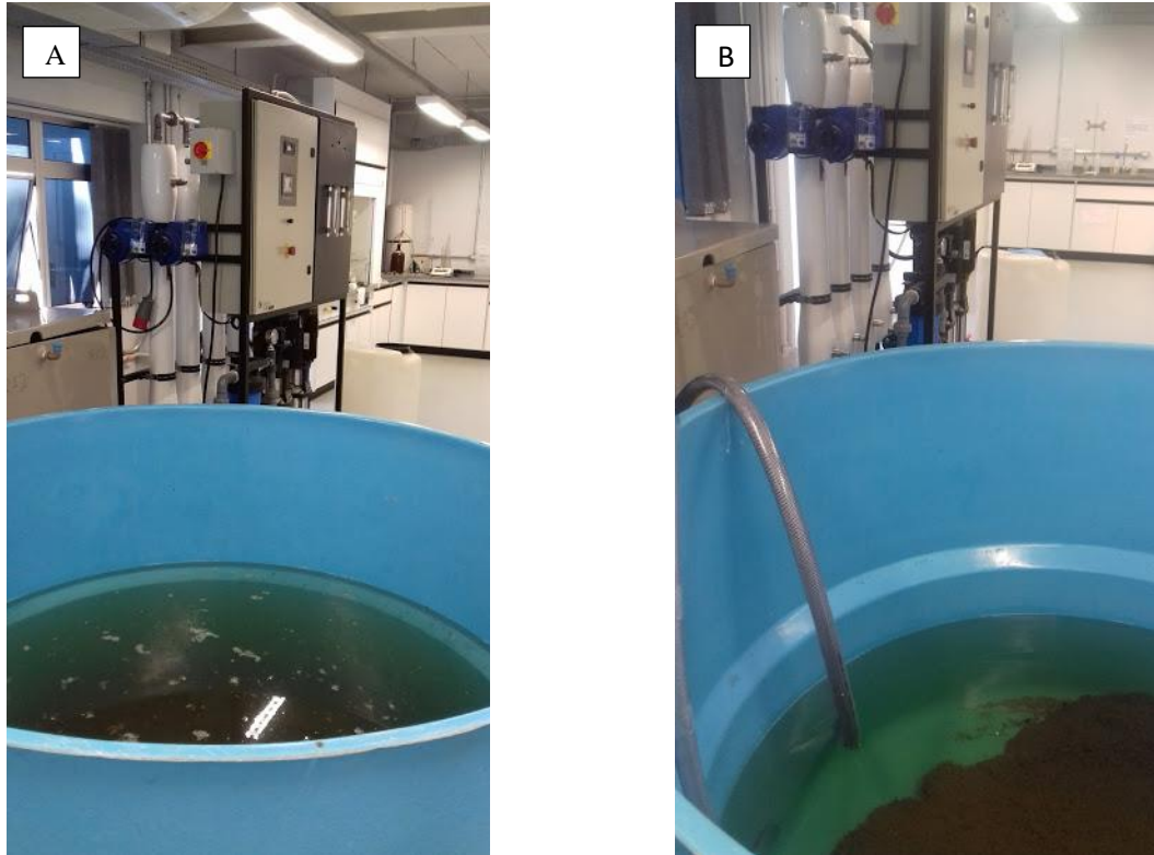
Figura 5: Armazenamento do esgoto em reservatório de fibra de vidro (A) e lodo do esgoto decantado após 1 dia de armazenamento (B).
