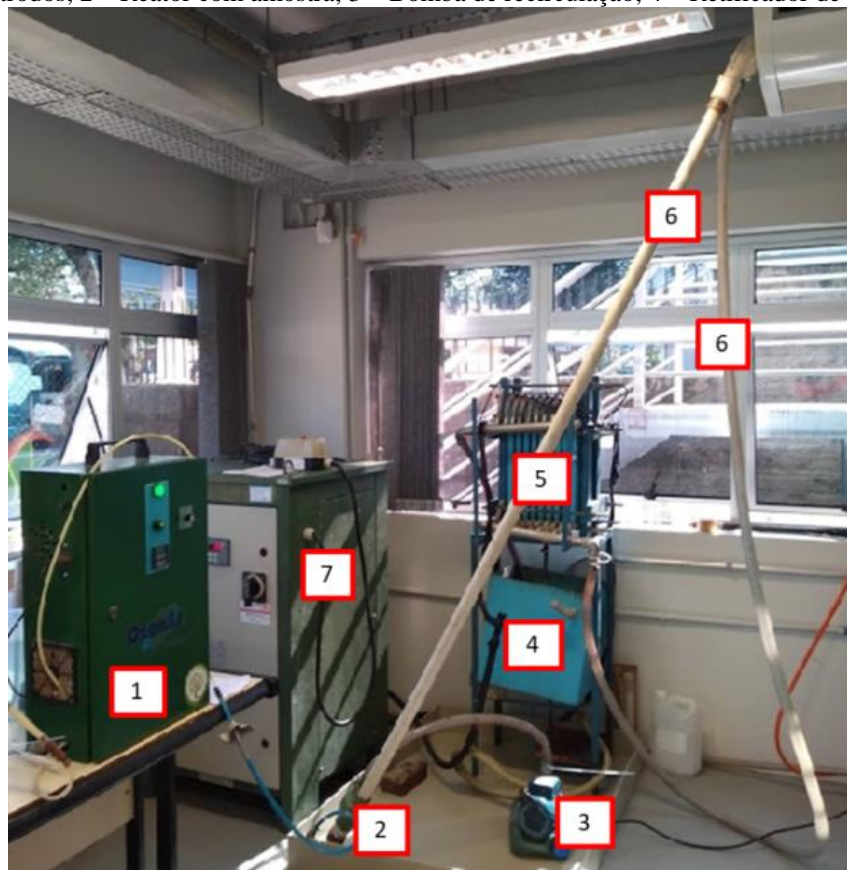
Figura 18: Sistema combinado de eletro-oxidação e ozônio (EO/O 3 ) do Laboratório Aquário – Universidade Feevale.
