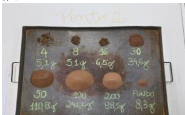
Figura 6. Tamanhos de peneiras utilizadas e seus respectivos pesos finais de solos no ponto 2.
