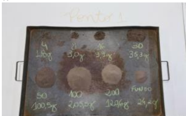
Figura 5. Tamanhos de peneiras utilizadas e seus respectivos pesos finais de solos no ponto 1.
