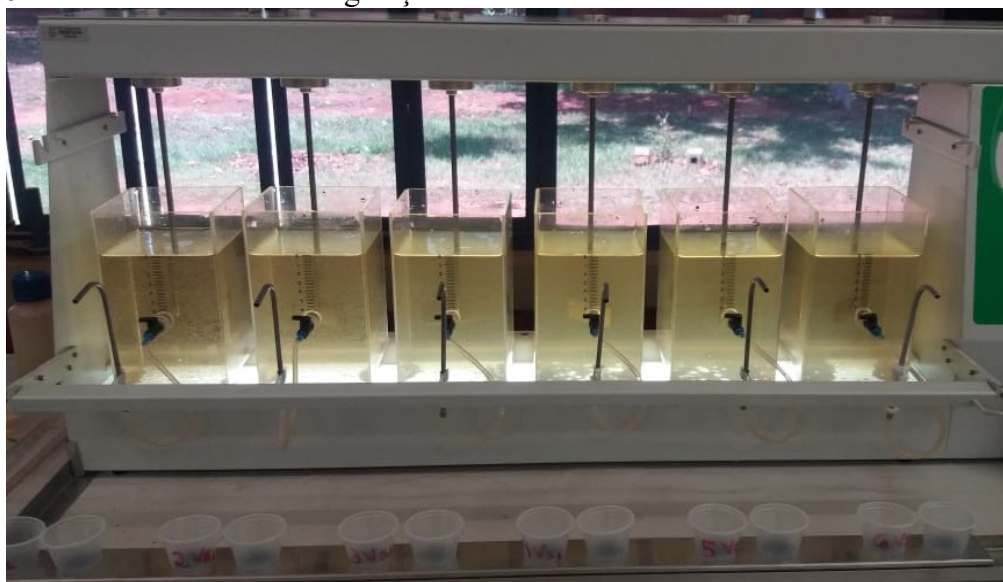
Figura 6- Ensaio 1: Ensaio de coagulação Sulfato de Alumínio.
