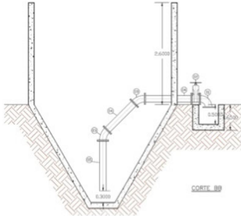
Figura 6 - Corte BB do tanque de sedimentação
