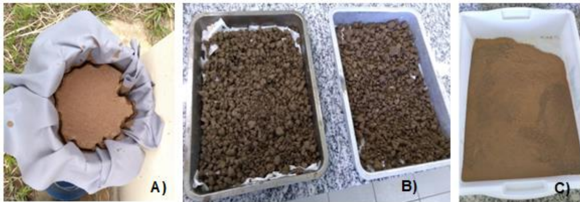
Figura 7 – Preparo do Lodo de ETA para os ensaios. A) adensamento gravitacional do lodo em meio filtrante (feltro + brita); B) destorroamento e secagem em estufa; C) lodo seco e peneirado
