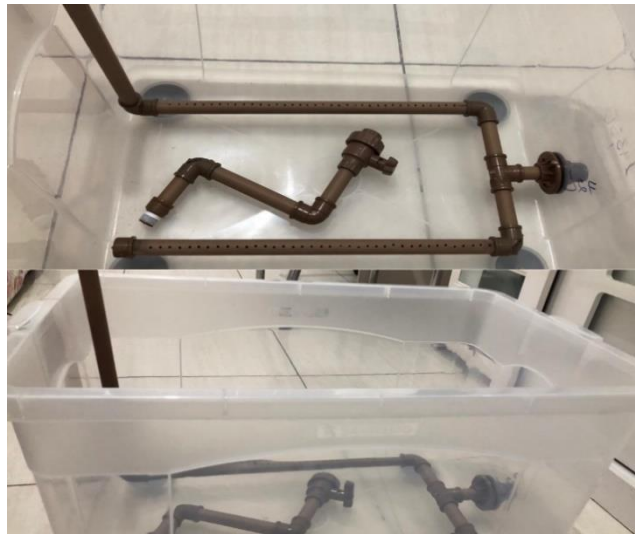
Figura 1: Construção do prototipo de Wetlands para tratamento de águas residuais
