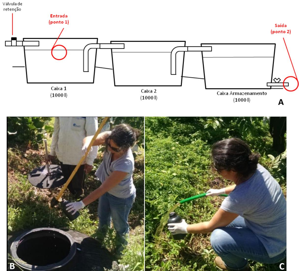
**Figura 6.3.** Pontos de coleta 1 e 2 do efluente do sistema Fossa Séptica Biodigestora. **A)** Esquema do local de retirada das amostras. **B)** Coleta da amostra de dentro da Caixa 1. **C)** Coleta da amostra da caixa 3 (biofertilizante), por meio da mangueira de aplicação do efluente.
