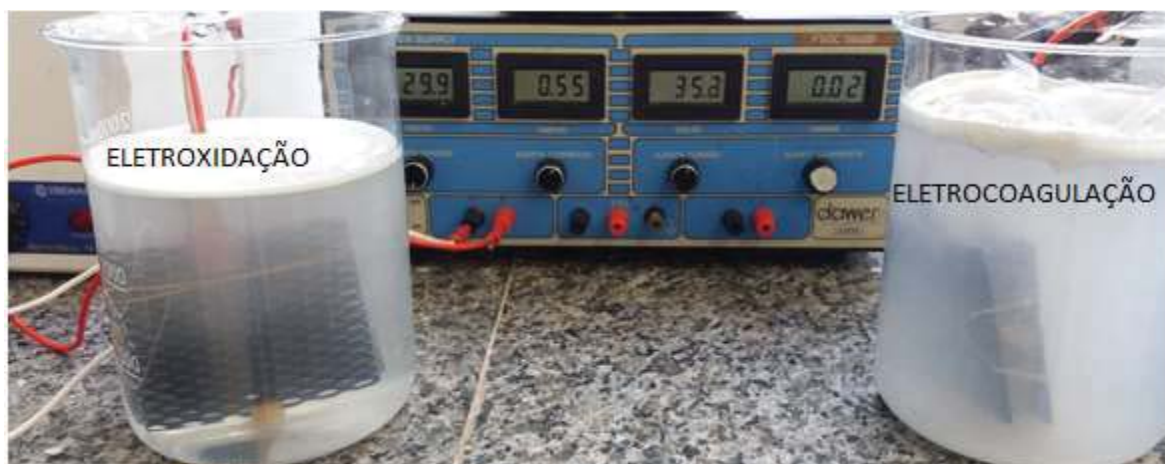
Figura 8 – Sistema eletrolítico em batelada.
