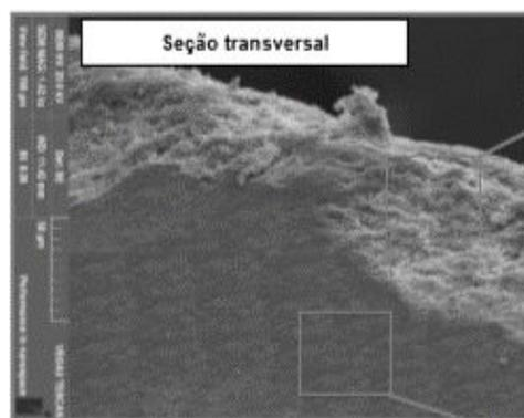
**Figura 4.** Micrografia do suporte cerâmico  $\alpha$ -alumina.
