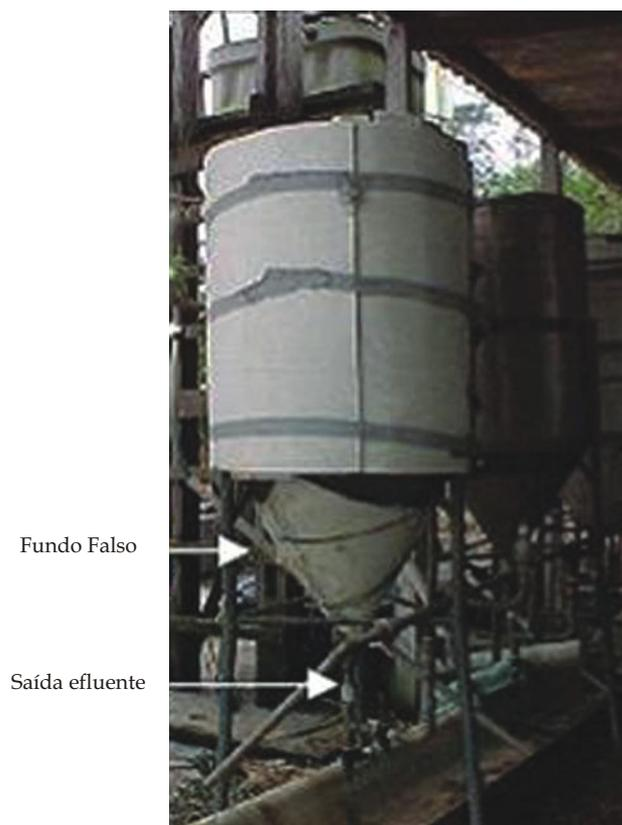
Figura 5. Reator anaeróbio com recheio de bambu. Fonte: Ronaldo Stefanutti.
