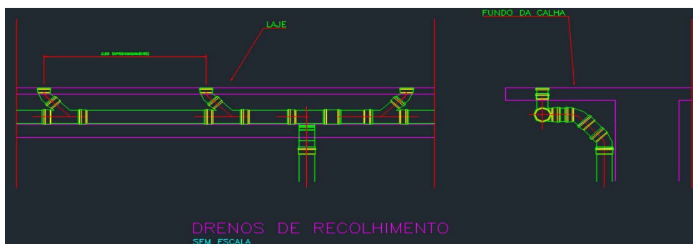
Figura 4: Sistema de captação nas calhas
