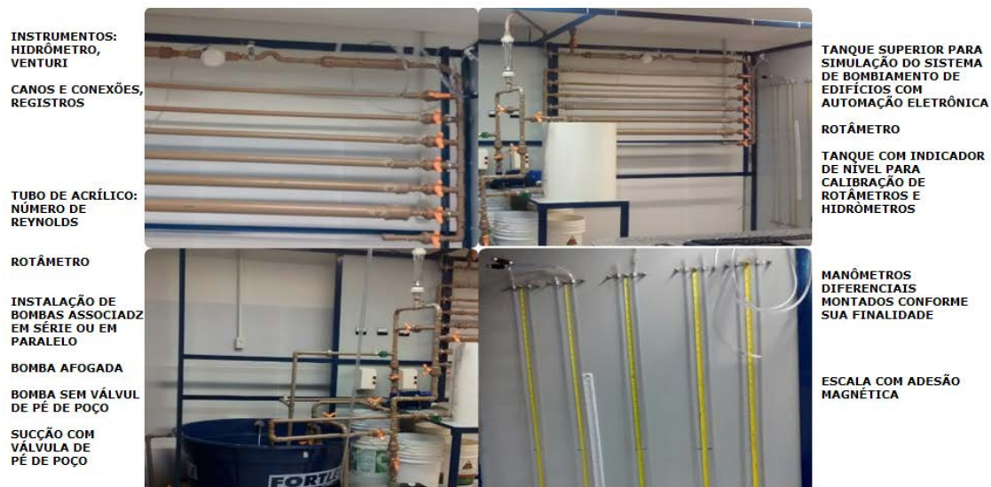
Figura 1. Painel hidráulico construído com materiais tecnológicos. Fonte: Próprio autor.
