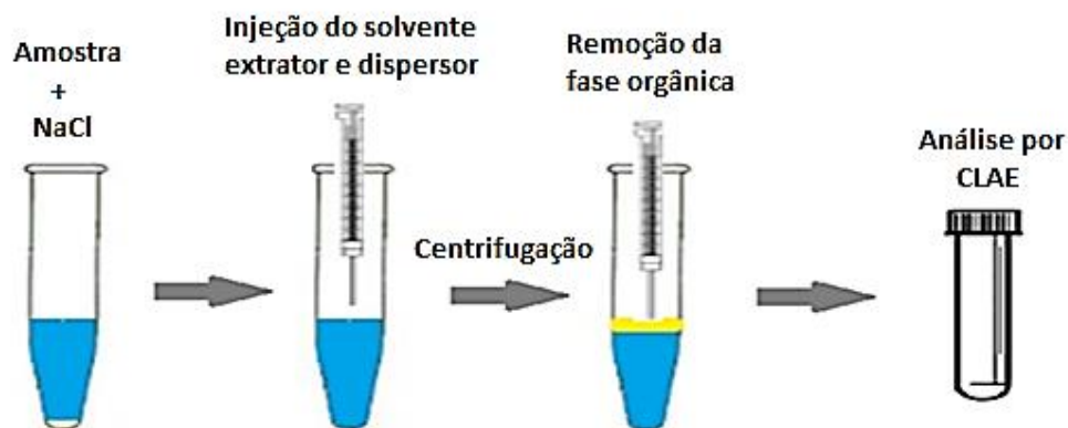
Figura 11- Etapas da microextração líquido - líquido dispersiva (DLLME) dos fármacos
