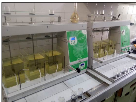
Figura 2: Jar Test com água bruta da ETA Castello Branco.
