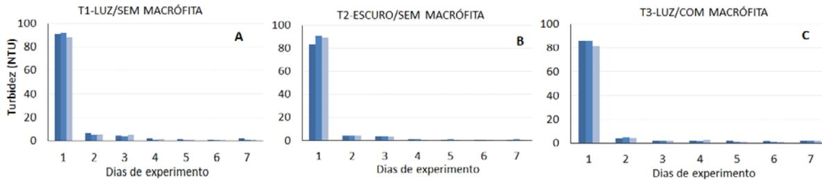
**Figura 2. Remoção de turbidez ao longo do experimento. a) T1: sem macrófitas e com efluente têxtil em béquer sem cobertura; b) T2: sem macrófitas e com efluente têxtil em béquer coberto por papel alumínio; c) T3: com macrófitas e com efluente têxtil em béquer sem cobertura**
