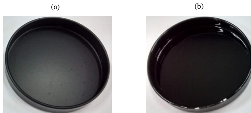
Figura 3.15 – Placas absorvedoras de radiação com a tinta comercial preta: (a) pintura interna e (b) pintura externa.
