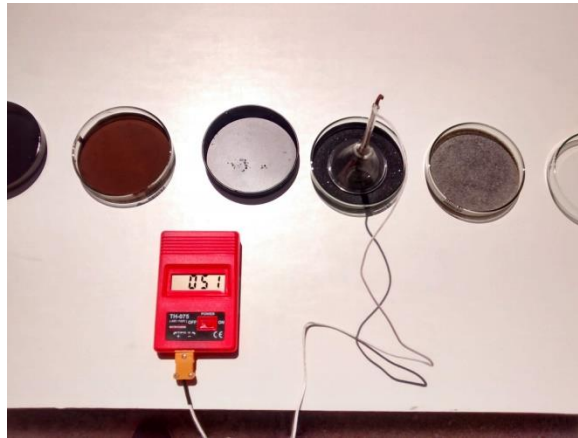
Figura 3.23 – Leitura da temperatura da superfície de uma placa absorvedora em um experimento solar na ausência de salmoura.
