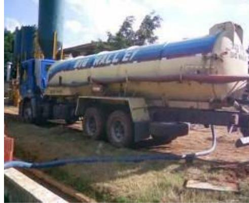
**Figura 12: Sucção de água por empresa de tratamento de esgoto.**
