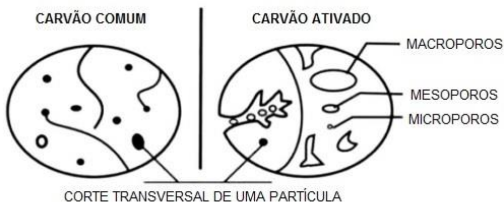
Figura 9 - Corte transversal em uma partícula de carvão comum e carvão ativado. Fonte: HUANG et al. (2010), adaptado.
