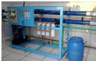
Fig. 2 – Equipamento de osmose reversa
