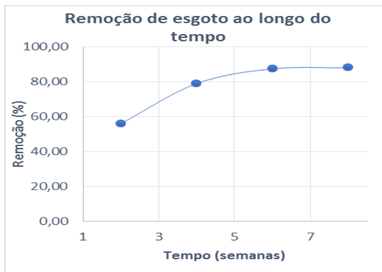
Gráfico 01: Remoção de DQO do esgoto durante ambientação da manta de microrganismos utilizada no protótipo de reator
