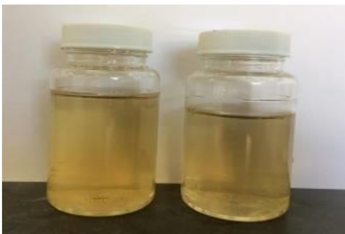
Figura 4: A) Cor do efluente tratado após o Foto-Fenton e B) Cor do efluente tratado após processos Foto-Fenton + reator UASB
