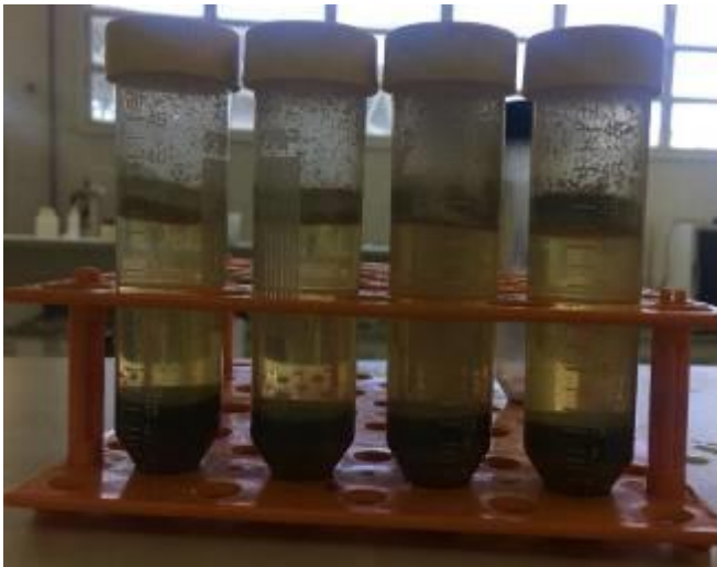
Figura 2: Remoção de DQO e turbidez do chorume pelo processo utilizando o polímero natural
