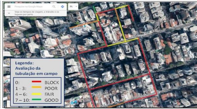
Figura 4 e 5: Mapeamento da rede de esgotos.
