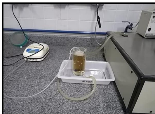
Figura 3: Esquema do reator para a remoção de compostos recalcitrantes de efluente de papel e celulose tratado previamente por lodos ativados.
