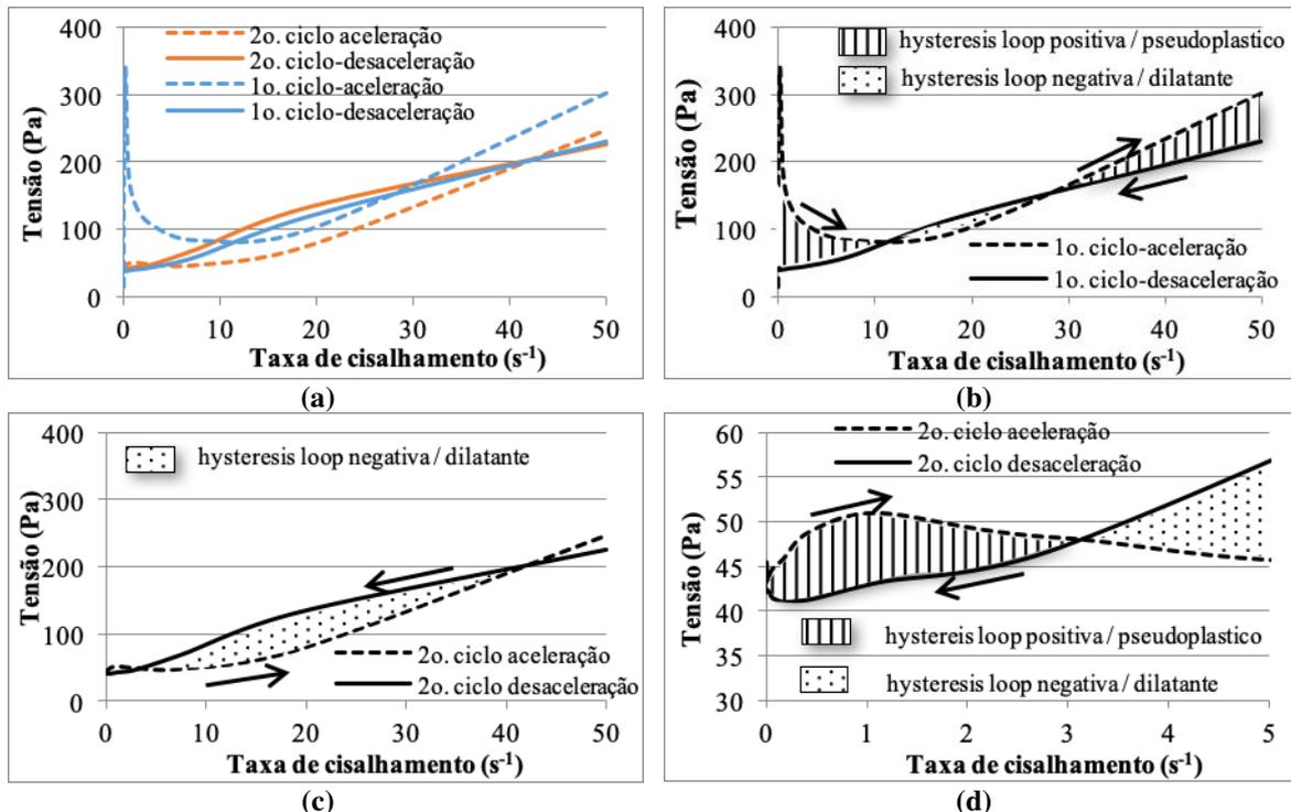
**Figura 6: Curvas dos ensaios de reometria rotacional de fluxo do tipo “step change”:** (a) para ambos os ciclos de aceleração-desaceleração; (b) para o primeiro ciclo; (c) para o segundo ciclo; (d) detalhe do segundo ciclo para baixos valores de taxa de cisalhamento. Fonte: modificado de Tsugawa et al. (2019).
