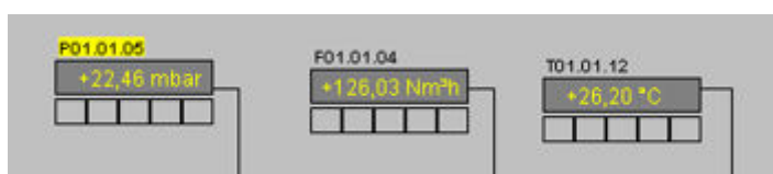
Figura 3 – Tela com registros de pressão, vazão e temperatura do biogás na entrada do contêiner.
