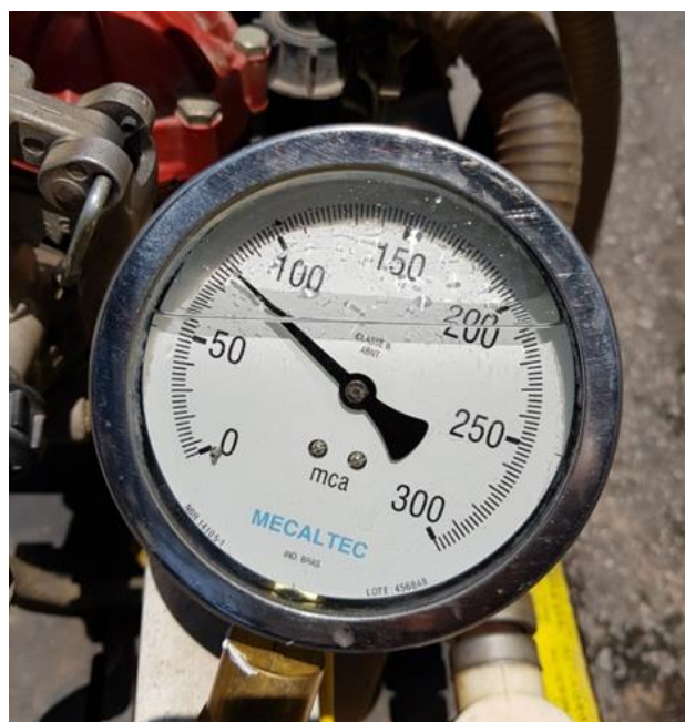
Figura 5: Pressão registrada após a etapa de estabilização.
