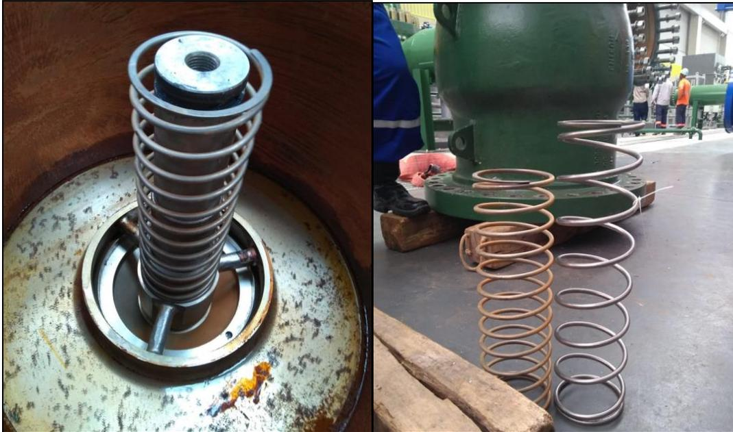
Figura 24 – Nova mola de 1.400N já trocada (vista interna da válvula) e a diferença visual entre a mola de 250N e a de 1.400N.
