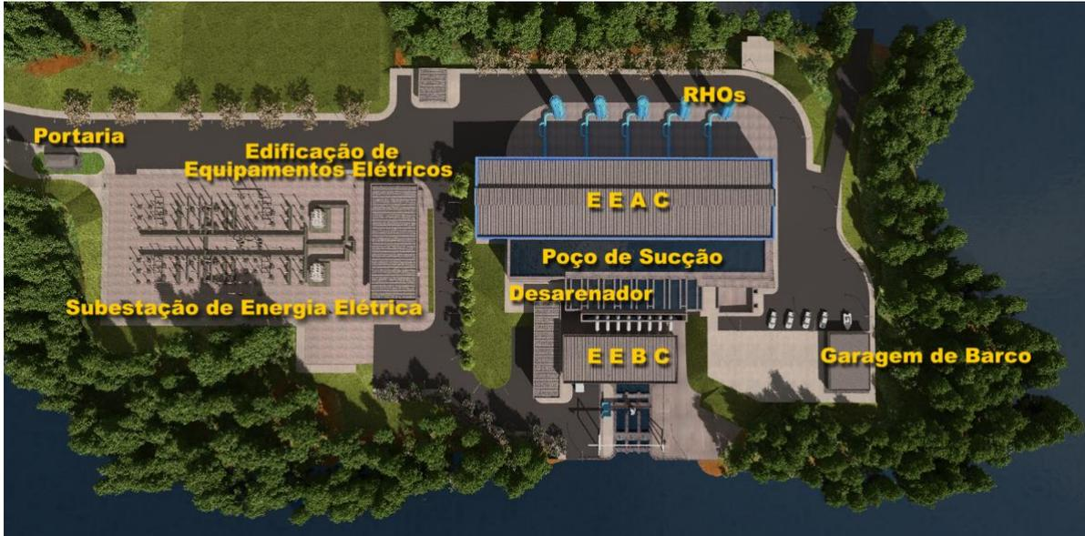
**Figura 2 – Identificação das Estruturas de Bombeamento**
