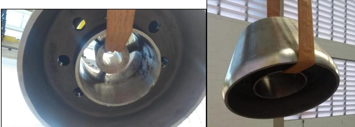
**Figura 26 – Furação realizada no “Nozzle” da válvula para se evitar o efeito “copo sobre copo” que gera vácuo impeditivo de fechamento da válvula de retenção.**
