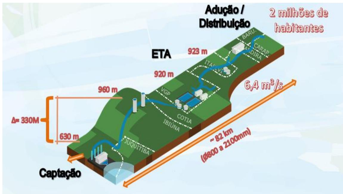
Figura 1 – Esquemático de Adução e Distribuição do SPSL
