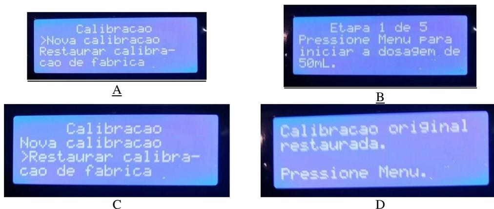
**Figura 4: Representação das etapas para calibração da bomba de coleta.**
