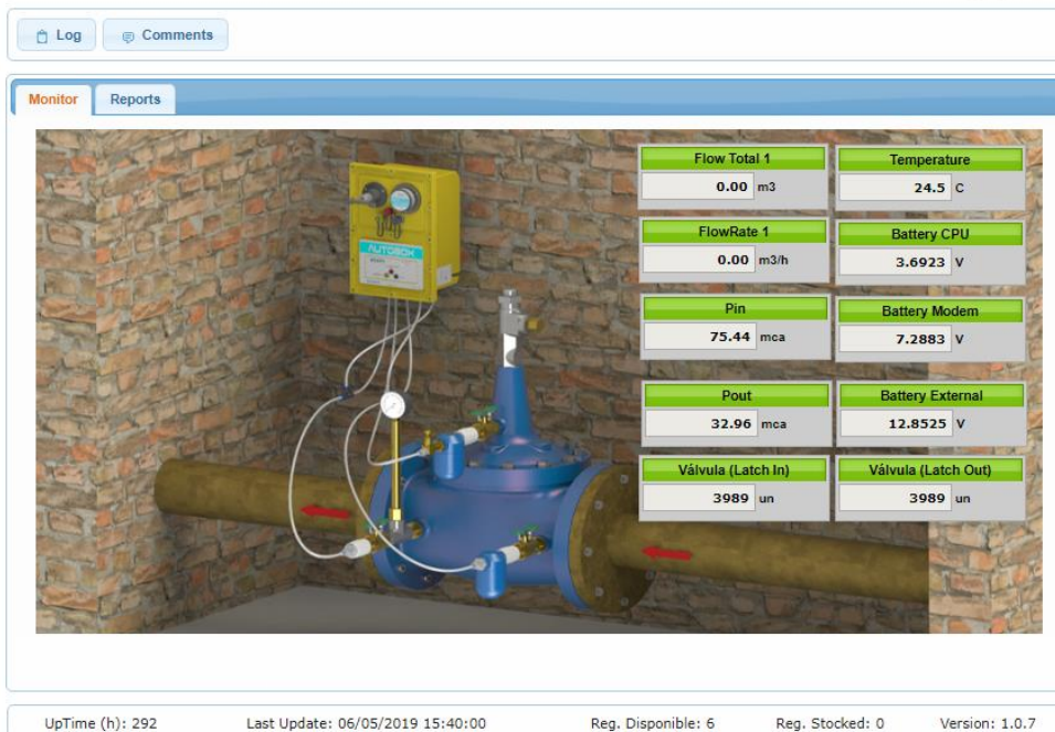
Figura 5: Aplicação do controlador de VRP Vectora (Fonte: Adaptado da aplicação do controlador de VRP Vectora)
